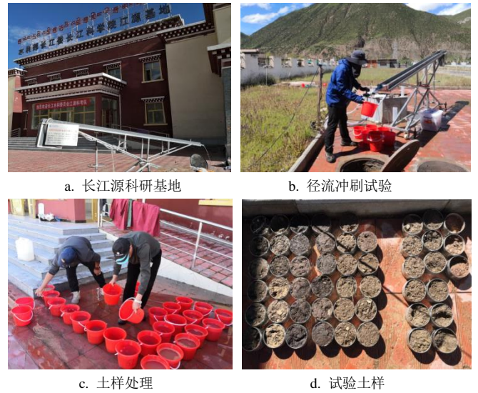
图3 长江源野外科学站径流冲刷模拟试验
